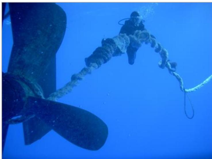
Figura 4. Hélice bloqueada por uma amarra de reboque de navio com 5 cm no navio HI'ALAKAI do NOAA a 80km a sul das ilhas Nihoa, Ilhas do noroeste havaiano (Source: NOAA).
